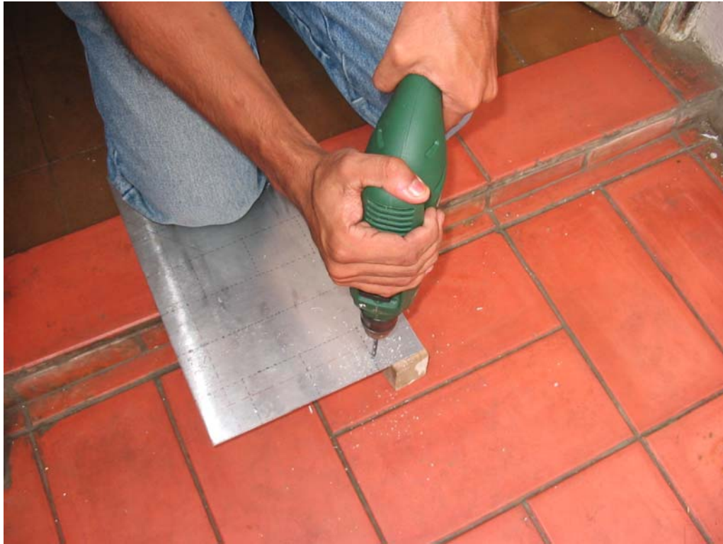
Figura 4.4. Perforación de láminas de aluminio para su ensamblaje.
