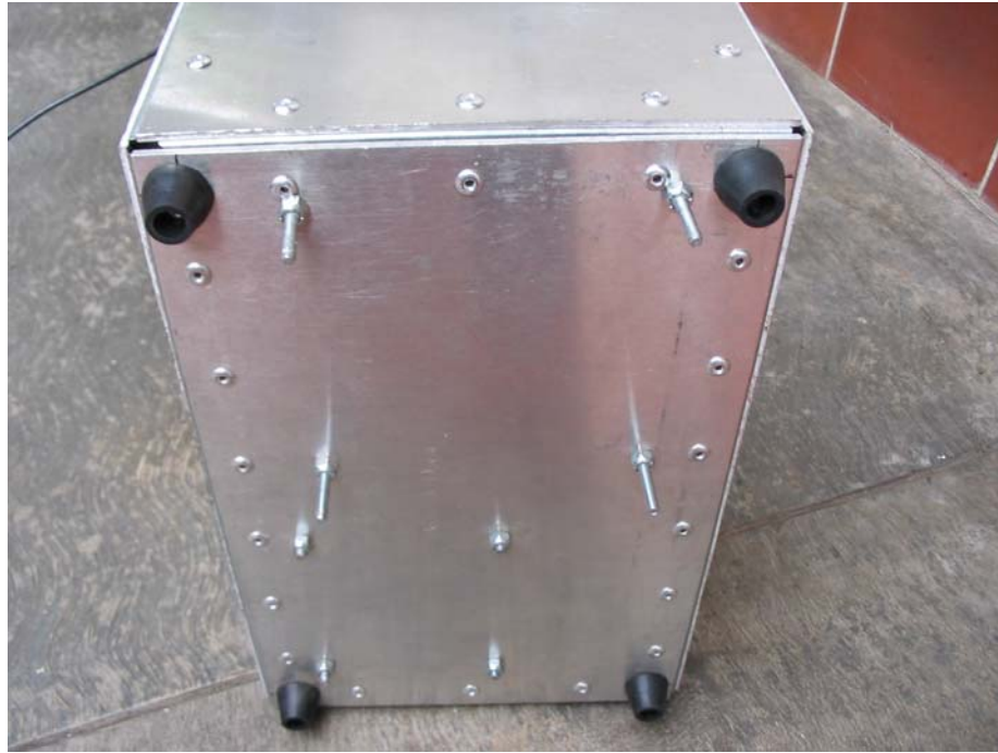
Figura 4.8. Tornillos de seguridad que sujetan al variac y al transformador
