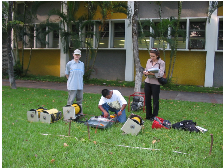
Figura 4.14. Disposición Schlumberger para ambos equipos
