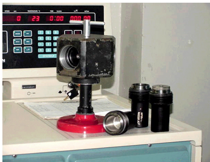
Figura 4.10- Rotor y envases para centrifugado de tapones
