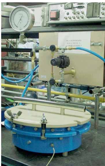
Figura 4.6- Equipo de drenaje de muestras por altas presiones
