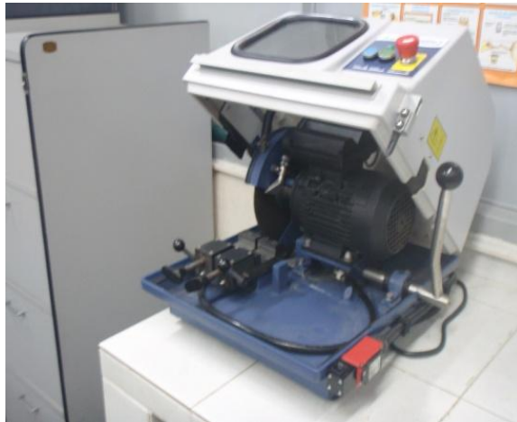
Fig. 14 Cortadora con disco de diamante abrasivo cutter marca Buehler modelo SamplMet 2
