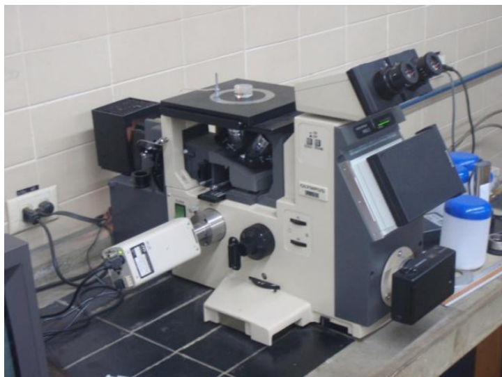
Fig. 21 Microscopio óptico polarizado marca OLYMPUS, modelo PMG 3
