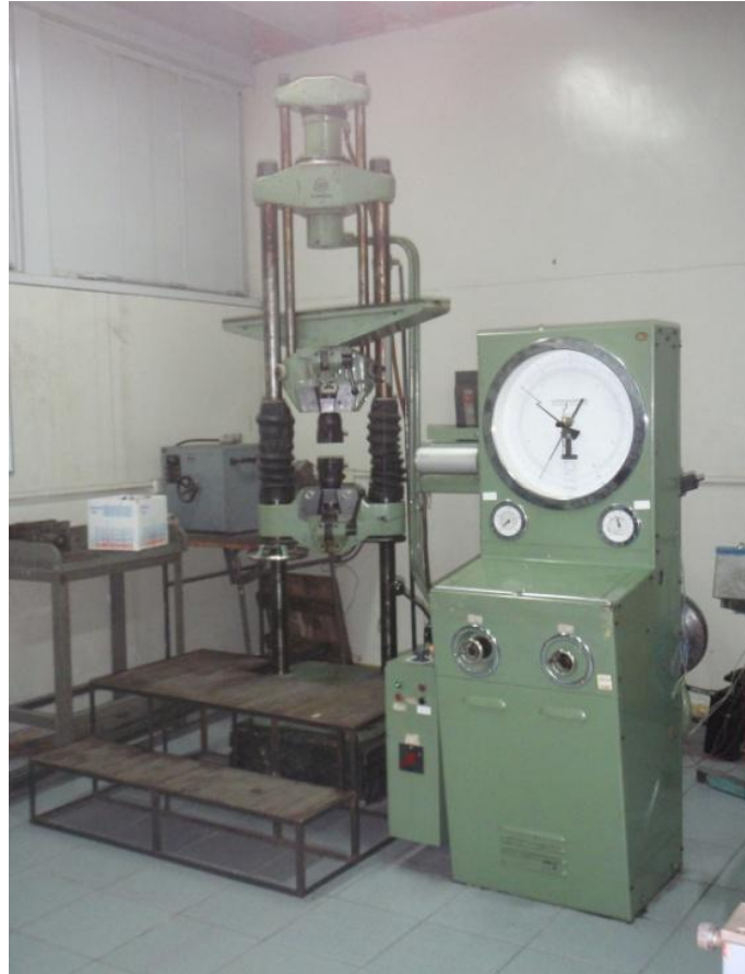
Fig. 8 máquina de ensayo modelo LOSENHAUSEN modelo Steuerpult z. UPH 20 de la EIM-UCV
