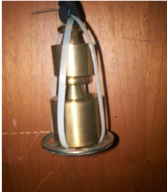
Figura 4.21.- Peso necesario para girar el pomo
