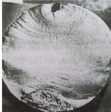
Figura 2.17.- Superficie de fractura con sollicitación de carga variable suave.
