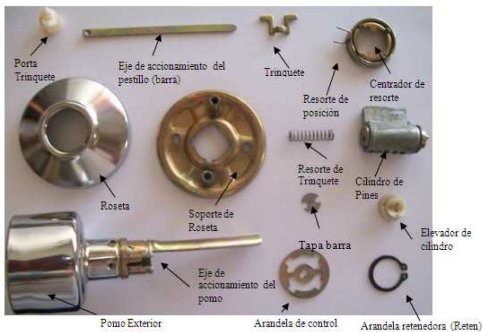
Figura 2.3. Elementos del pomo exterior
