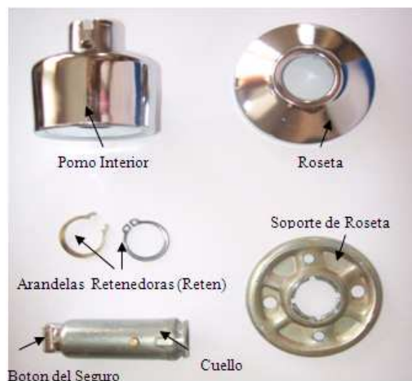
Figura 2.2.- Elementos del pomo interior
