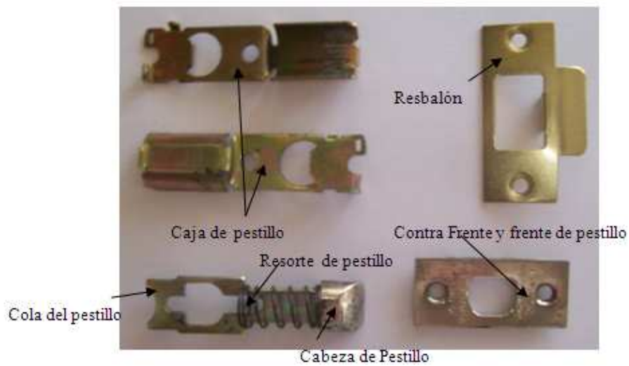
Figura 2.4. Elementos del pestillo
