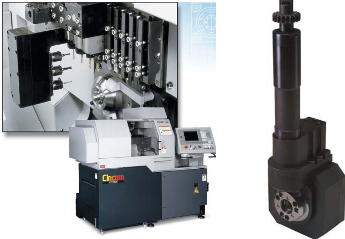
Figura 37. Torno tipo suizo marca Citizen Cincom con accesorio para roscado por remolino.
