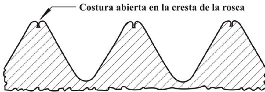
Figura 13. Costura abierta en la cresta de una rosca causada por el rápido fluir del metal a lo largo de los bordes del dado.
