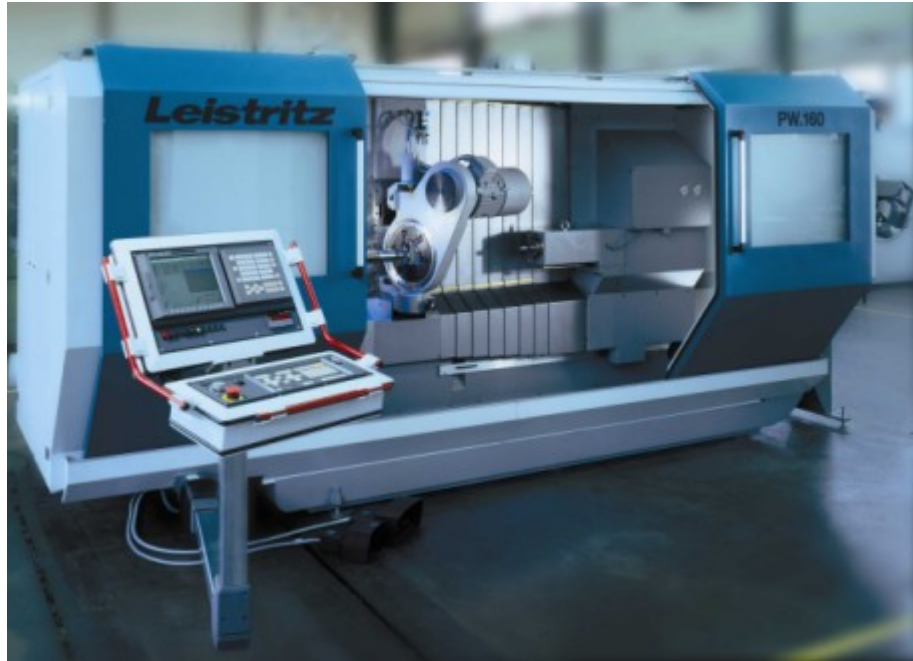
Figura 36. Máquina de roscado por remolino
