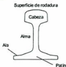
Figura 2.5 - Riel de patín plano. Fuente: Oliveros (1977)
