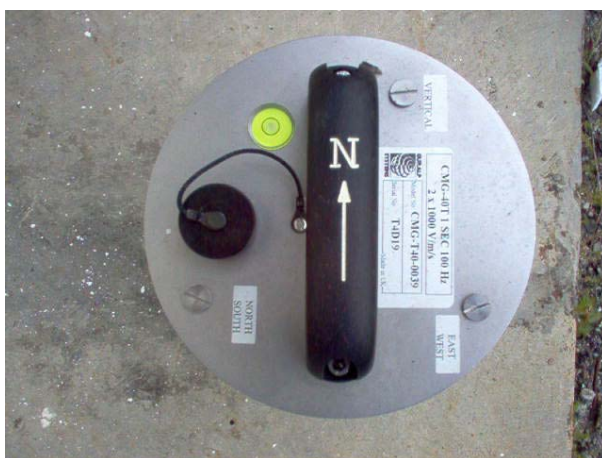
Fig. N° 9a y 9b. Sismómetro portátil de 3 componentes, marca Guralp, modelo CMG-40T
