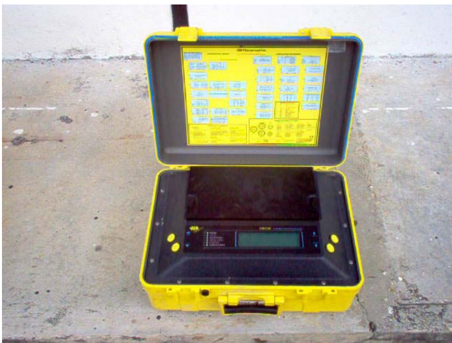
Fig. N° 10. Sismógrafo digital portátil, marca Nanometrics, modelo Orion.
