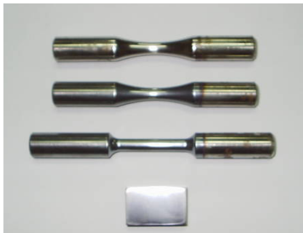
Figura 2.4 Probetas empleadas. En orden descendente: Probeta para fatiga sin recubrimiento, Probeta para fatiga recubierta, probeta para tracción recubierta, probeta para dureza recubierta.
