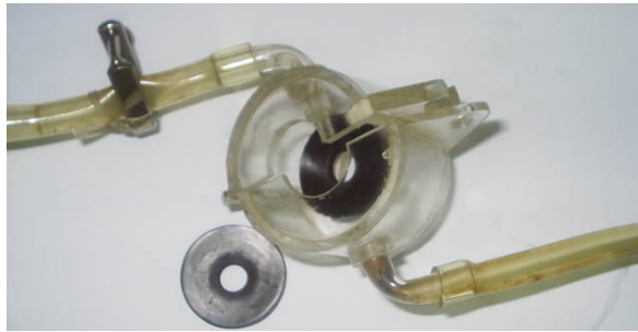
Figura 2.13 Cámara de corrosión.
