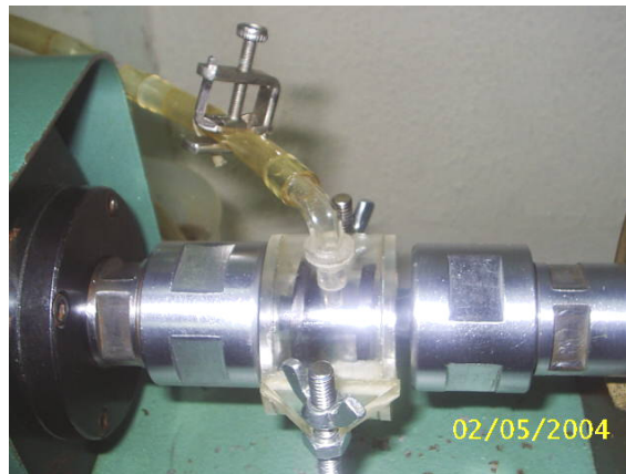
Figura 2.14 Montaje para ensayo de fatiga corrosión.
