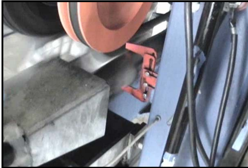
Figura 5.16.6 Sistemas de verificación de alineación de la guaya (Rope location).
