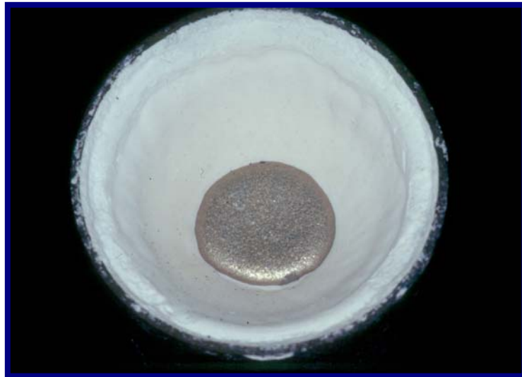
Gráfico 2. Vista inferior del anillo de colado donde se aprecia la aleación de níquel-cromo ya solidificada.
