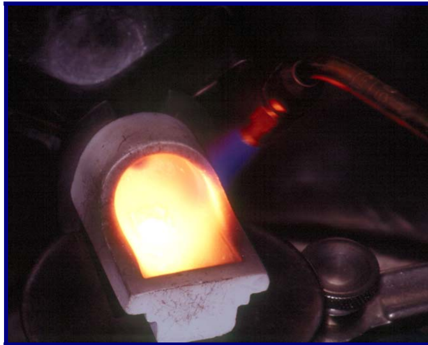
Gráfico 1. Momento en el que se funde la aleación de níquel-cromo para ingresar en la cámara de colado por medio de una fuerza centrífuga.
