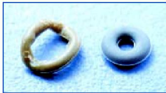
Figura 16 Pérdida de elasticidad de una ligadura elastomérica. Tomado de Matasa 1995 24
