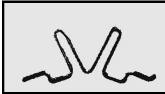
Fig. 23 Asa en "K" activada. Tomado de Kalra, 1995.
