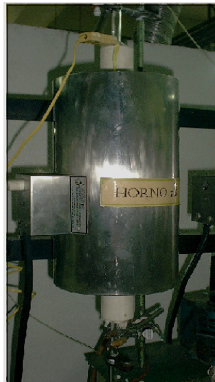
Figura 3.6: Equipo empleado en la calcinación de los catalizadores
