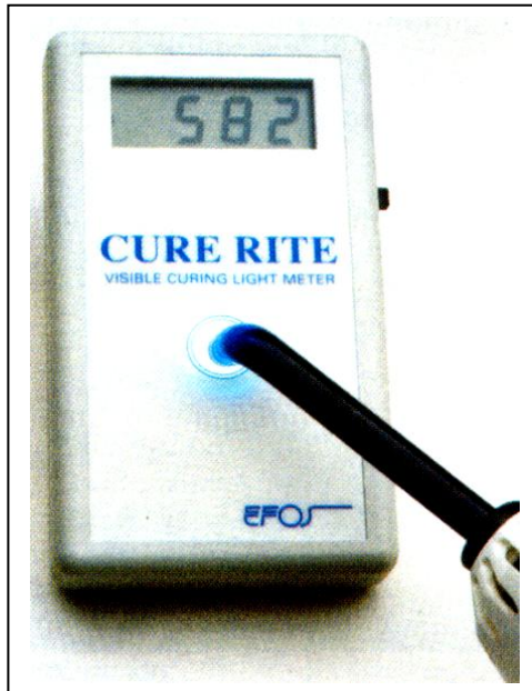
Gráfico 9. Vista frontal de un modelo de radiómetro. Tomado de Goldstein, 2002
