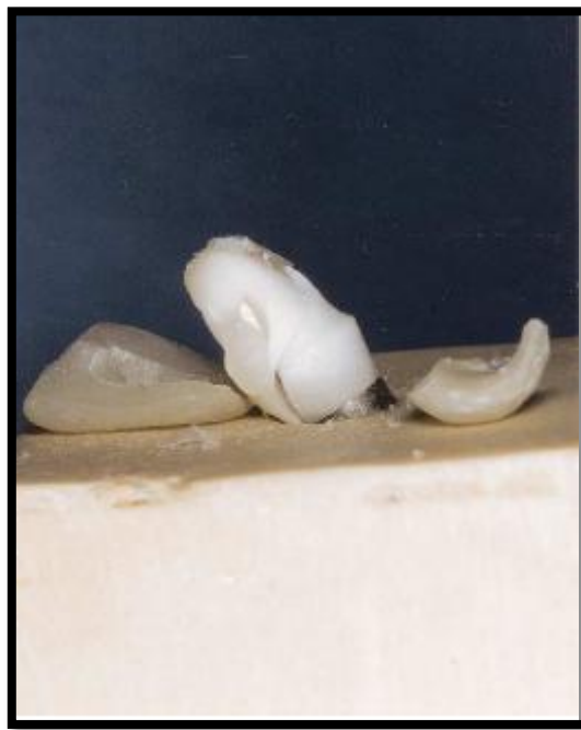
Gráfico 18. Fractura de corona total cerámica y pilar protésico de zirconio luego del procedimiento de prueba. Tomado de Yildirim et al, 2003
