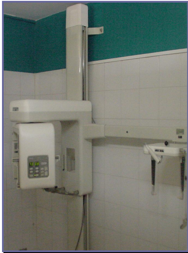
Gráfico 10. Equipo utilizado para la toma de radiografías panorámicas. Marca Belmont Equipment Corp. Modelo X-Caliber CM-C.
