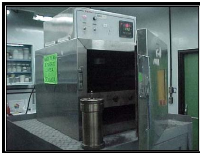
Figura 3.9 Horno de envejecimiento rotativo (Martínez, 2004)
