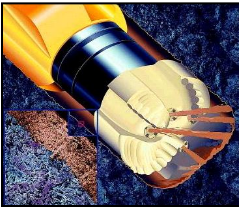
Figura 2.4 Representación Ilustrada de Transmisión de energía hidráulica a través de la mecha (Pernía, 2006).
