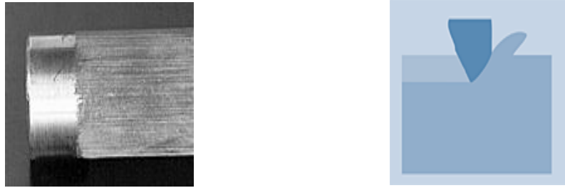
Figura 2.7 Desgaste por abrasión (Pernía, 2006).
