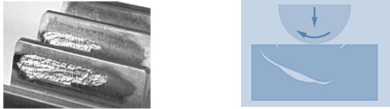
Figura 2.9 Desgaste por fatiga superficial (Pernía, 2006).
