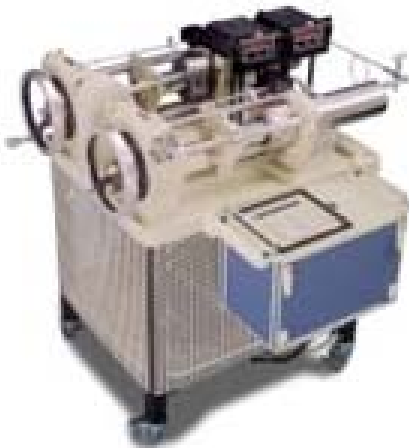
Figura 3.17. Bomba dual de desplazamiento positivo Ruska. (Ruska).
