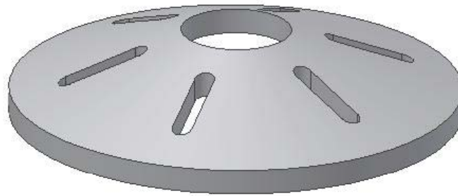
Figura 4.53. Agitador de la celda PVT. (El Autor).
