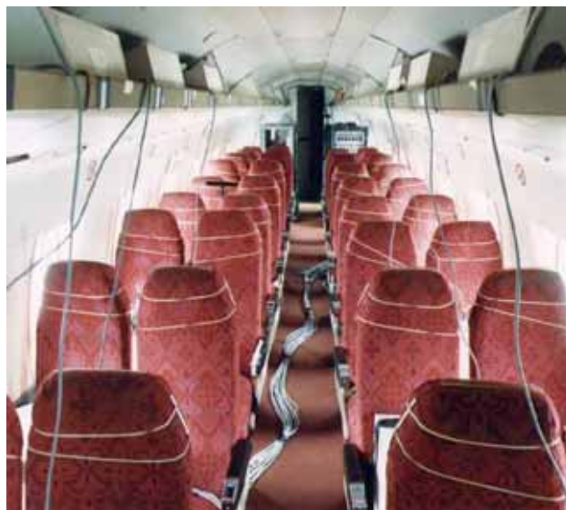
Arreglo de un sistema de control activo de ruido dispuesto dentro de un avión
