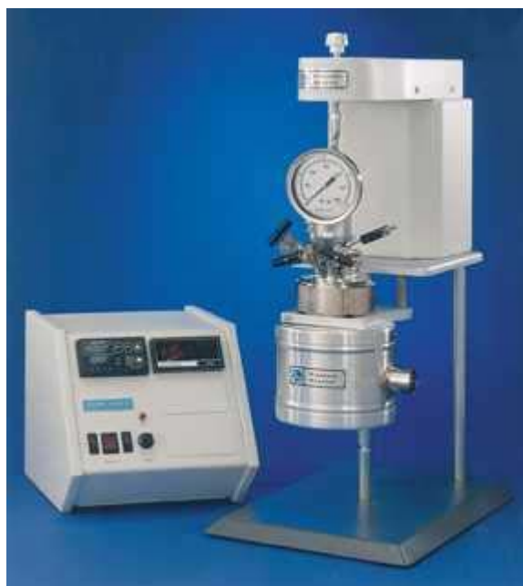
Figura 18. Reactor de Polimerización Autoclave Parr con Controlador de Temperatura y Transductor de Presión Parr
