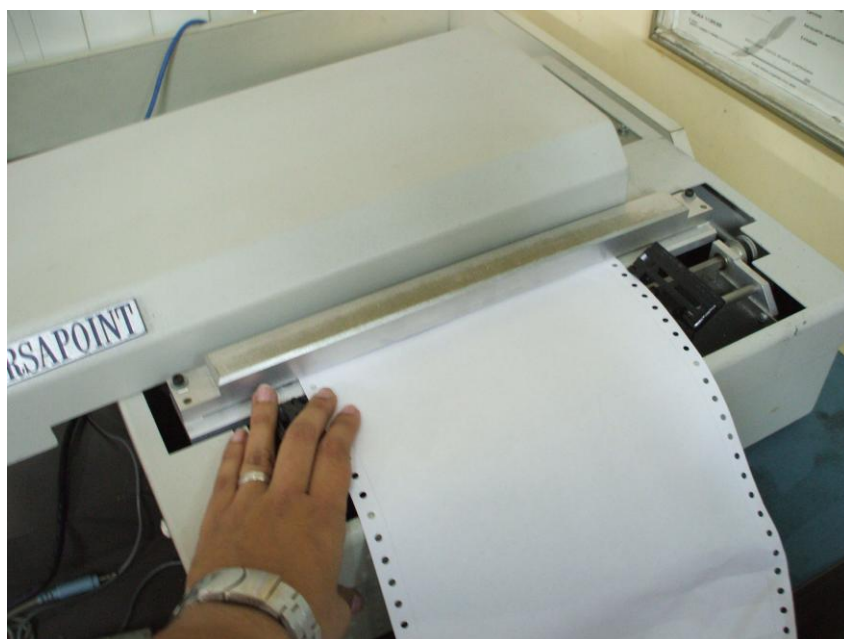
Fig.6: Preparando el papel para imprimir. Impresora Versapoint
