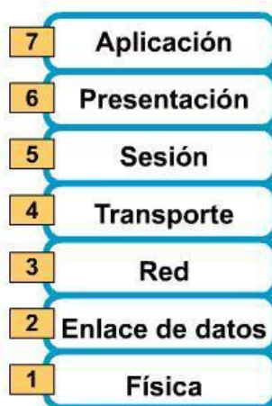
Figura 2: Capas del Modelo ISO-OSI [6]
