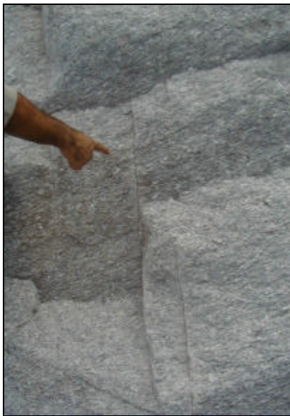
Fig. N° 17. Gneis, mostrando discontinuidades. Qda. San Julián.
