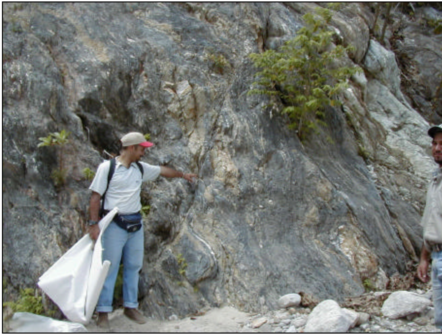
Fig. Nº 13. Esquisto calcáreo grafitoso, mostrando discontinuidades. Qda. Osorio. (Tomado de INGEOTEC, 2000).
