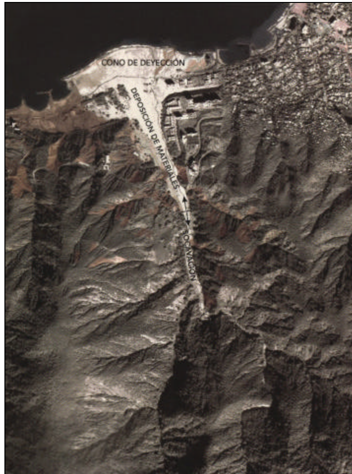
Fig. N° 11. Cono de deyección, río Camurí Chiquito. Desde el punto indicado hasta la desembocadura (depósito constituido por material más fino), aguas arriba (rocas de gran tamaño). (Tomada de MUGUERZA, 2001).
