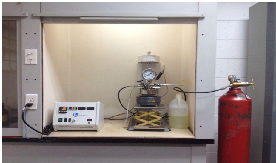
Figura N°9. Montaje del sistema de reacción catalítica.
