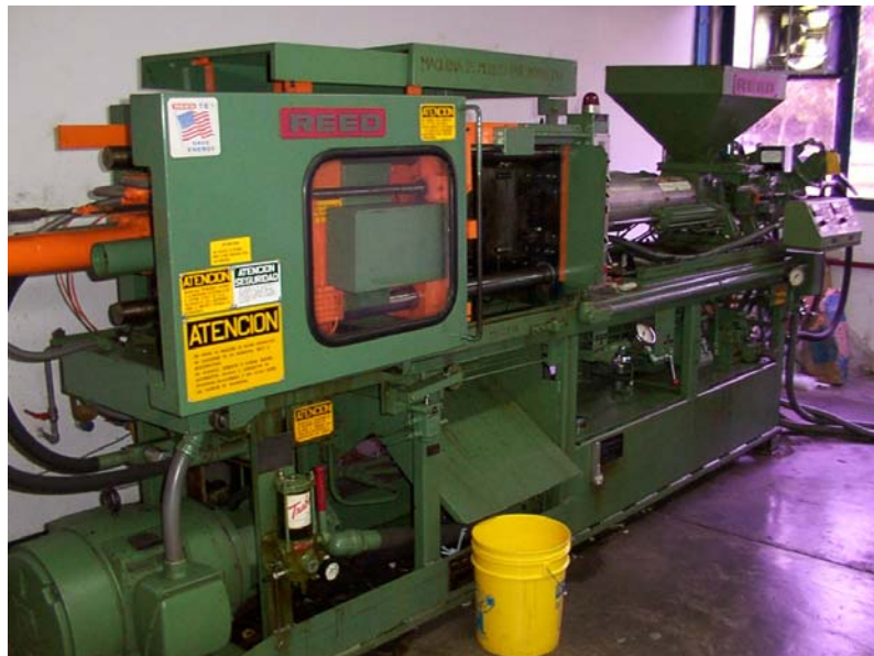
Figura N°17-A. Máquina de moldeo por inyección REED PRENTICE, modelo N°100 TE.
