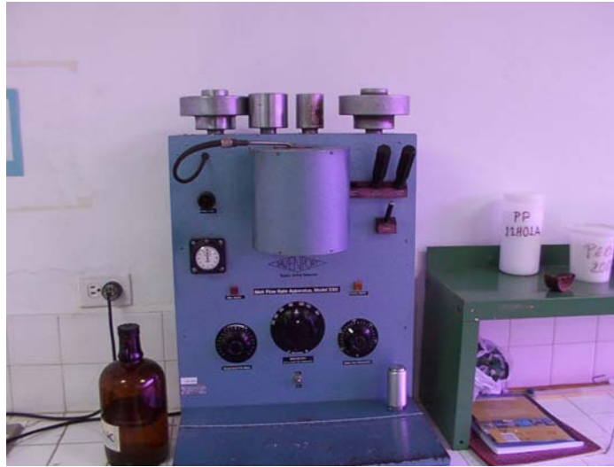
Figura N°27. Plastómetro, marca DAVENPORT, modelo 3/80.
