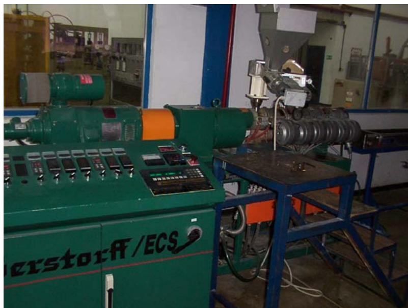
Figura N°14. Extrusora de doble tornillo co-rotante con 6 etapas de calentamiento, marca BERSTORFF/ECS.
