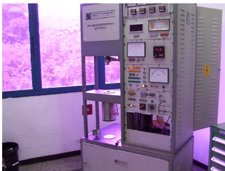
Figura N°28. Reómetro capilar RHEOGRAPH 2000, marca GÖTTFERT, y capilar de relación L/D 30/1.
