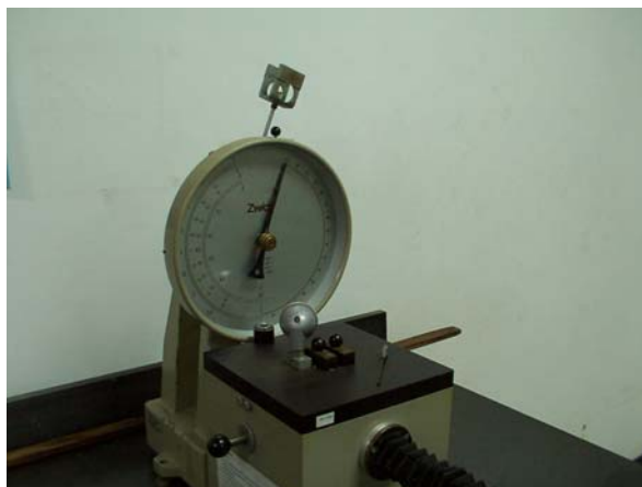
Figura N°23. Máquina de ensayos de impacto, ZWICK D7900, tipo 5102.
