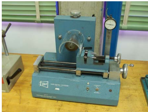
Figura N°22. Máquina de entallado, Testing Machines Inc., modelo TMI 43-15.
