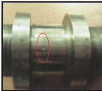
Figura 5.6. Falla producida por el ensayo de desgaste por rodadura en el eje 1
