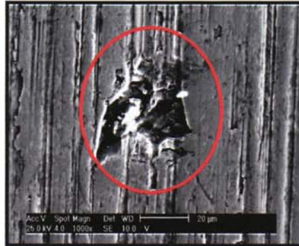
Figura 5.11. Vista general a 1000X de la muestra ensayada por desgaste por rodadura recubierta Soldadura TIG sin tratamiento térmico en modo de electrones secundarios
