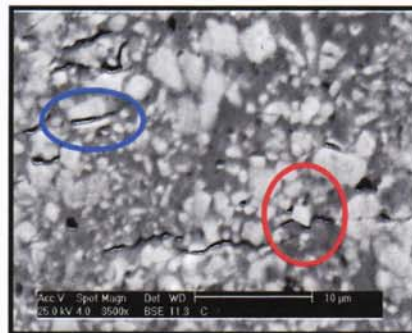
Figura 5.9. Micrografía a 3500X en modo de electrones primarios de la muestra ensayada por desgaste por rodadura recubierta con Colmonoy 88 tratada térmicamente
