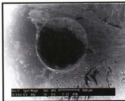
Figura 5.20. Micrografía en modo de electrones secundarios del pin utilizado para la muestra de Soldadura TIG sin ser tratada térmicamente a 40X
