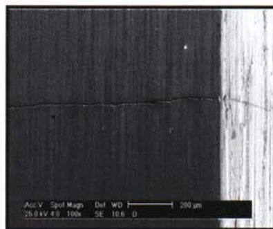
Figura 5.10. Micrografía a 100X en modo de electrones secundarios de la muestra ensayada por desgaste por rodadura recubierta con Colmonoy 88 tratada térmicamente
