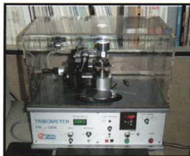
Figura 4.6. Vista frontal del Tribómetro
