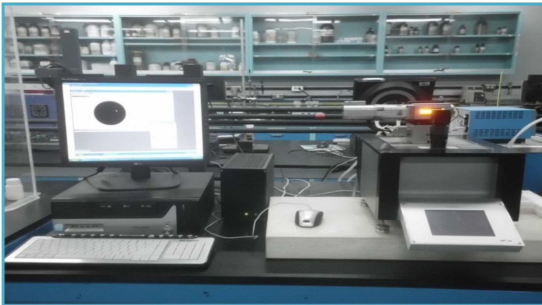
Figura 4. 8. Tensiómetro de la gota giratoria “ Spinning Drop SVT 20 ”. (Aguirre, 2013)
