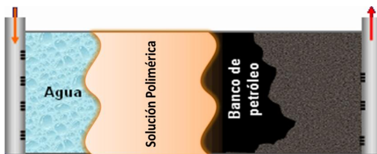
Figura 2. 4. Proceso de inyección de polímeros [18]
