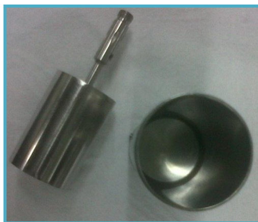
Figura 4. 13. Camisa y rotor del viscosímetro HAKKE (Geometría), (Aguirre, 2013)
