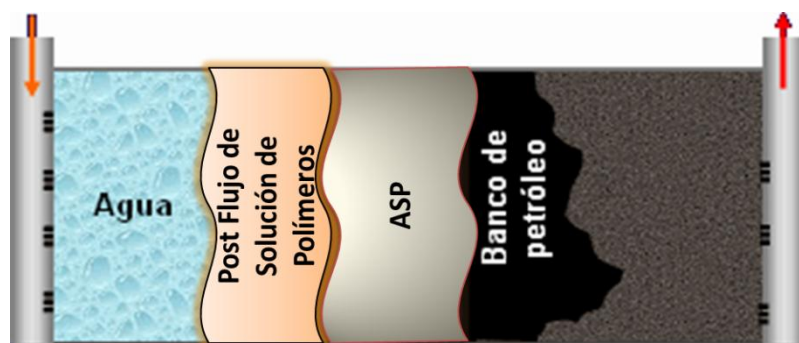
Figura 2. 7. Proceso de Inyección ASP [18]
