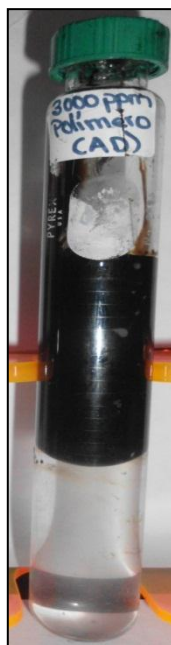
Figura D. 2. Comportamiento de fases del sistema crudo/3000 ppm solución acuosa de polímero, luego de 24 horas de evaluación a una temperatura de 50°C.
