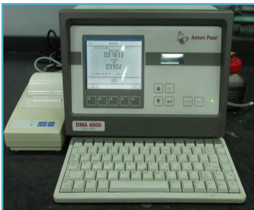
Figura 4. 3. Densímetro DMA 4500 (Aguirre, 2013)
