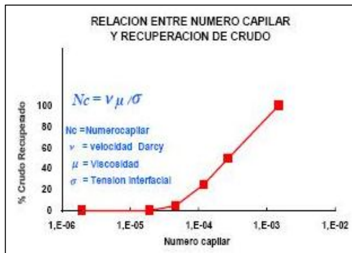
Figura 2. 24. Relación entre el número capilar y recuperación de crudo [39] .
