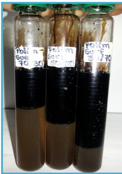
Figura 5. 15. Formulaci3n 3000 ppm de polímero-1000 ppm de surfactante/3%KCl (pH=10) a diferentes relaciones crudo/agua: 70/30, 50/50 y 30/70
