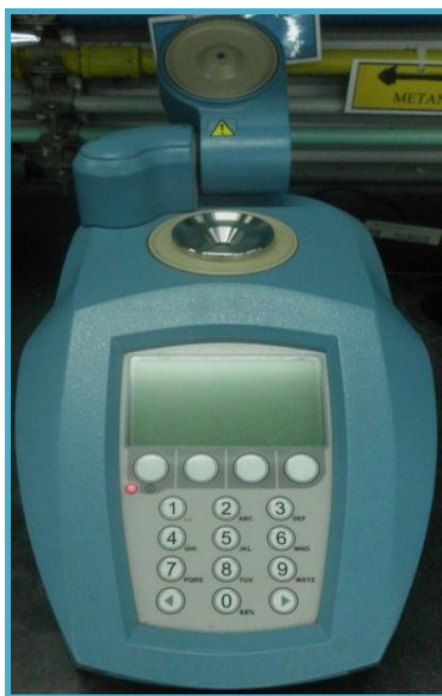
Figura 4. 4. Refractómetro RF M800 (Aguirre, 2013)
