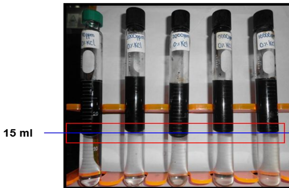
Figura 5. 3. Comportamiento de fases del sistema crudo/ (70, 1000,2000, 5000 y 10000 ppm) solución acuosa de surfactante/0% p/p KCl, (pH=10)
