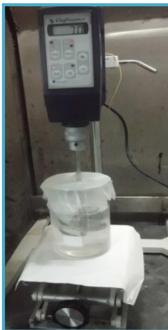
Figura 4. 6. Agitador eléctrico digital marca CAFRAMO (Aguirre, 2013)
