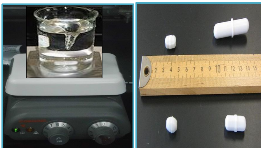
Figura 4. 5. Agitador Magnético y barras magnéticas (Aguirre, 2013)
