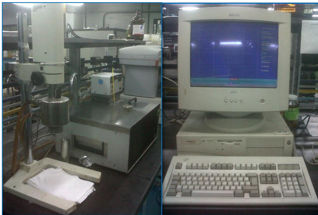
Figura 4. 12. Viscosímetro HAKKE, (Aguirre, 2013)
