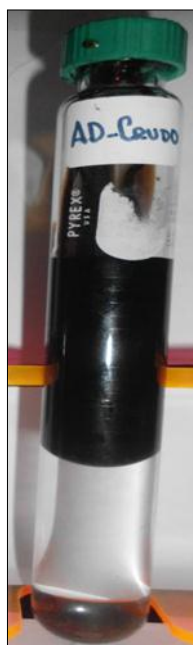
Figura D. 1. Comportamiento de fases del sistema crudo/ agua destilada (Blanco), luego de 24 horas de evaluación, a una temperatura de 50°C.
