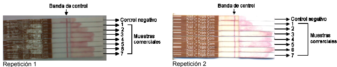
Figura 1. Resultados de la aplicación de las tiras de flujo lateral en muestras comerciales de soya.
