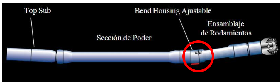
Figura 18. Esquema Básico Externo de Motor de Fondo [7] . Modificado por Eduardo Morante.
