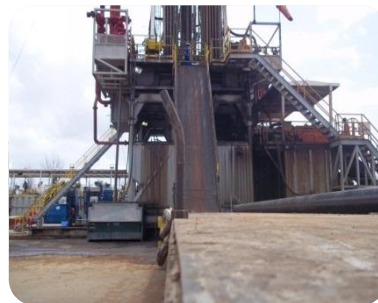
Figura 15 - Rampa de tubería [Aristimuño y Briceño, 2012]
