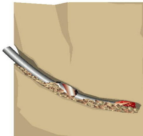
Figura 63 - Limpieza del hoyo (Schlumberger, s.f.) [23]
