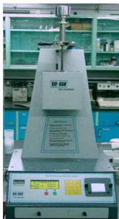
Figura N° 12: Máquina para el Índice de fluidez, marca Ray – Ran Advanced Melt Flow System.
