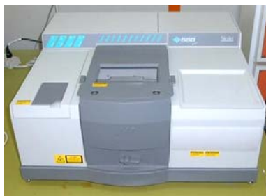
Figura N° 11: Espectrómetro de Infrarrojo por transformada de Fourier (FT-IR), Nicolet, modelo Magna-IR 560
