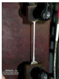
Figura N° 13: Ensayo de tracción de una probeta de polietileno.
