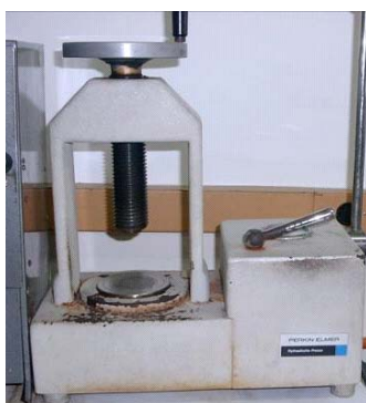
Figura N° 10: Prensa hidráulica marca Perkin-Elmer
