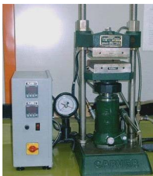
Figura N° 9: Prensa hidráulica de moldeo marca Carver, modelo C
