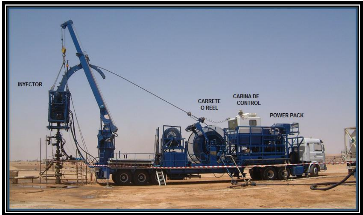
Figura II.8: Componentes de una Unidad de Coiled Tubing . [13]
