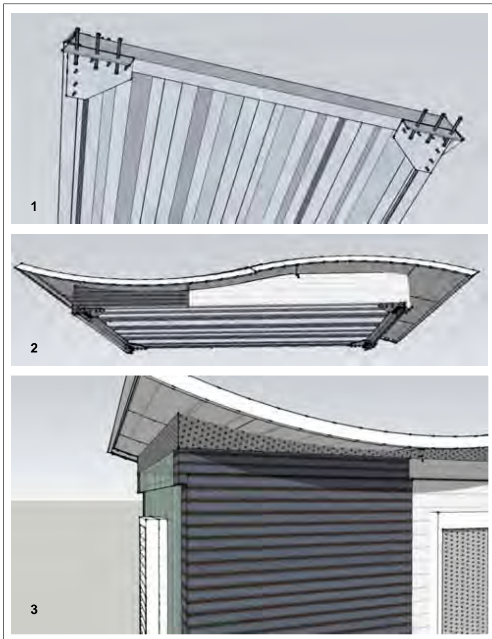
Figura. 79 Conformación del techo: 1. Detalle del elemento de anclaje, 2. Techo listo para ser colocado en sitio, 3. Vista del módulo con el techo. Fuente: Elaboración propia 2008
