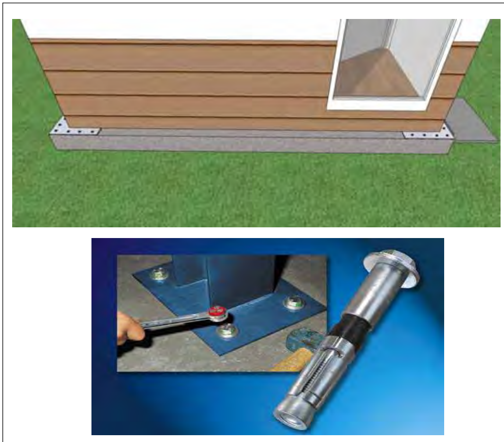
Figura. 99. Fijación del módulo en sitio. Fuente: Elaboración propia. 2008 / Ramplug HIL-TI. Fuente: http://comunicacionempresarial.net 2008
