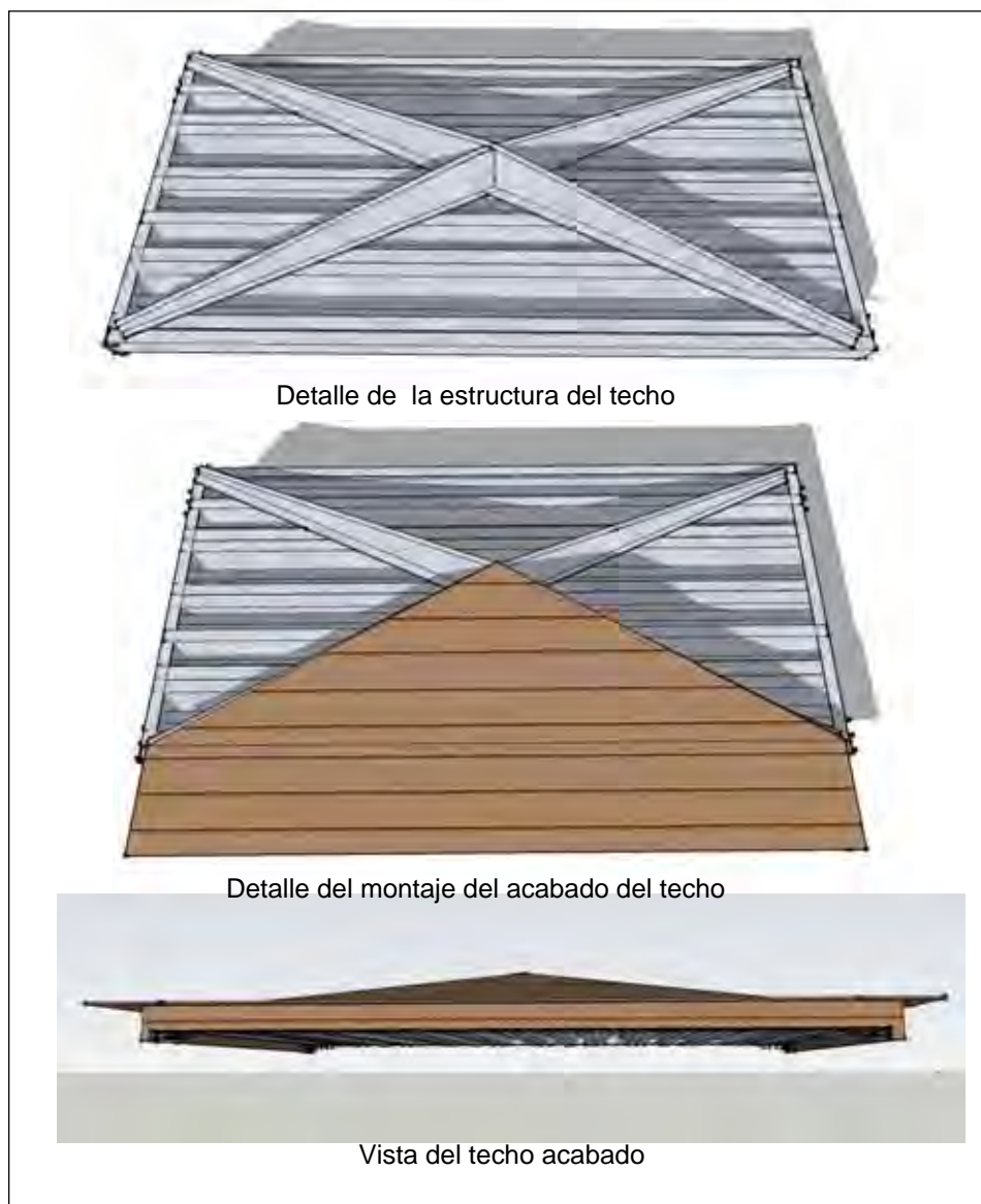
Figura. 78. Ensamblaje Techo. Fuente: Elaboración propia 2008
