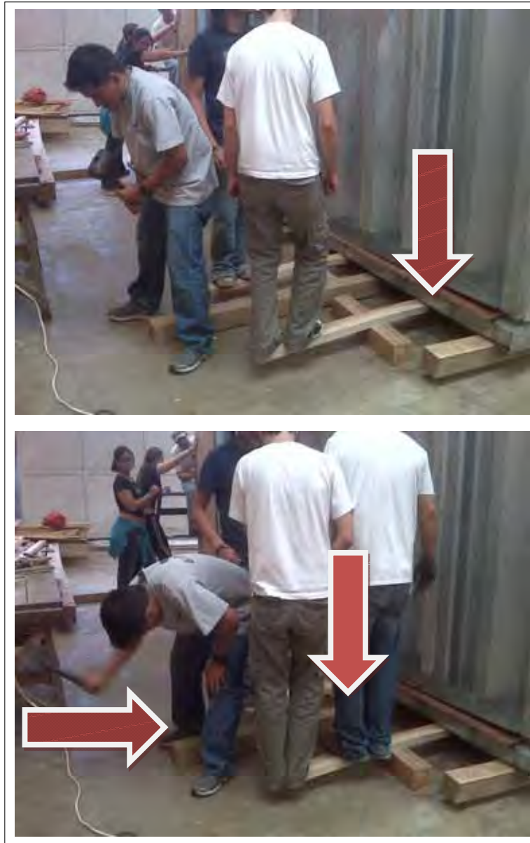
Figura. 130 Aplicación de fuerzas externas al Módulo A.
