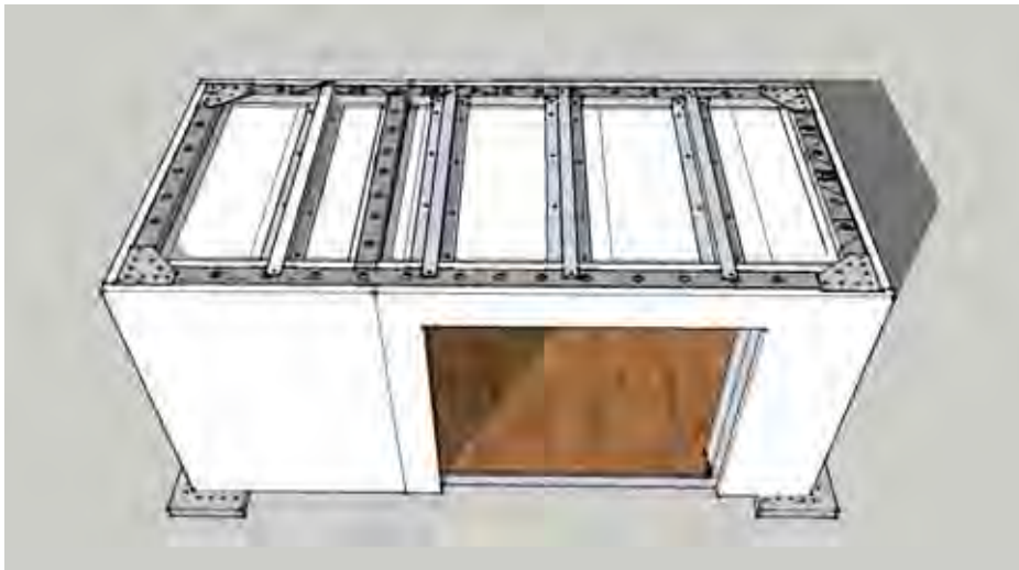
Figura. 138. Módulo A. Montaje del cielo raso: Elaboración propia
