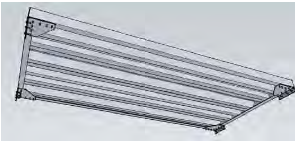
Figura. 143 Estructura base del techo.: Elaboración propia 2010
