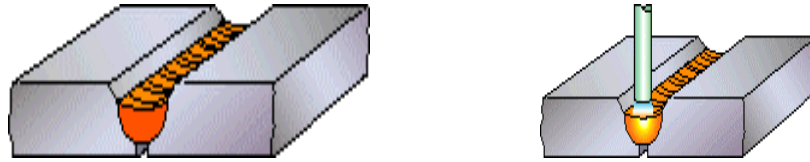
Figura 13. Representación de una soldadura con falta de penetración (Fuente TWI)
