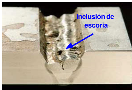
Figura 12. Inclusiones de escoria (Fuente TWI)
