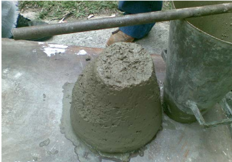
Foto N° 7. Asentamiento de la Mezcla. Fotos de autor (2008)
