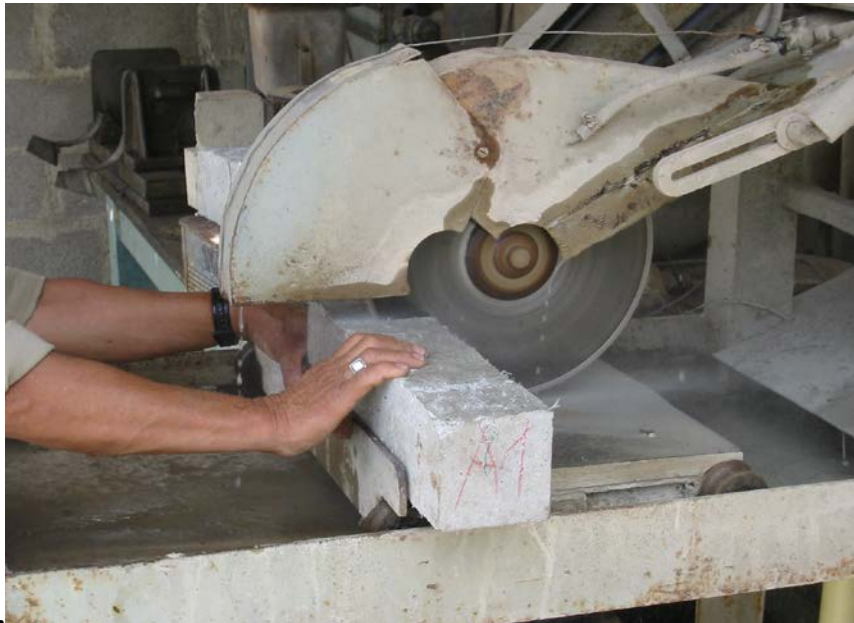
FOTOS N° 11 Corte de las muestras para la aplicación de pruebas de flexión y compresión. Fotos de autor (2008).
