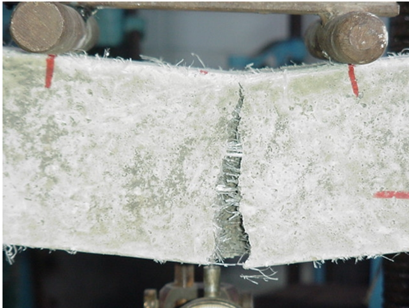
Foto N° 9. Ensayo de Flexión, vista de Rotura del Material. Fotos de autor (2008)
