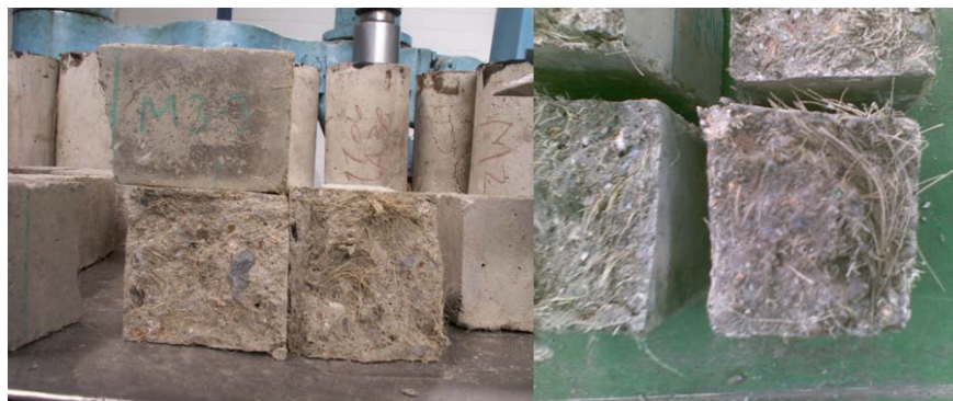
FOTOS N° 12 Corte de las muestras para la aplicación de pruebas de flexión y compresión. Fotos de autor (2008).
