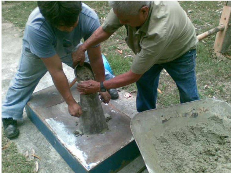
Foto N°6. Realización de Prueba de Asentamiento. Fotos de autor (2008)
