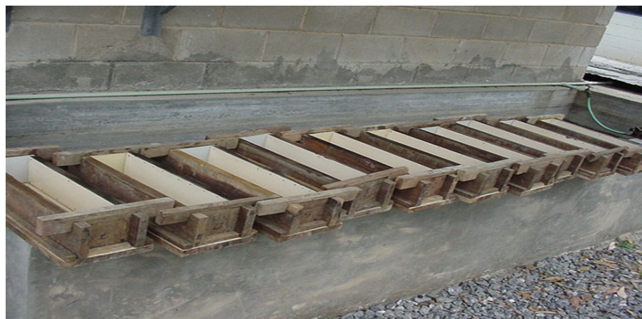
Foto N° 10. Encofrado para las Probetas Prismáticas Fotos de autor (2008)
