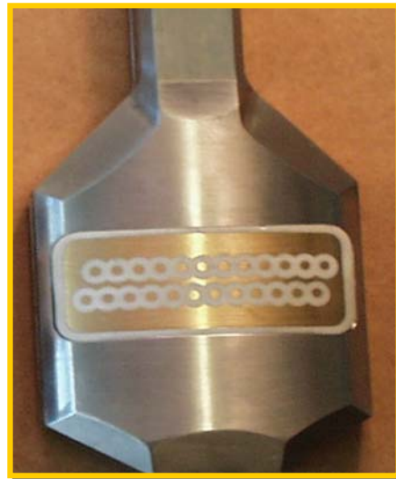
Figura A.4. Patín de la herramienta STAR donde se muestran dos filas de 12 botones (Tomado de Baker Atlas Logging Services, 2002)
