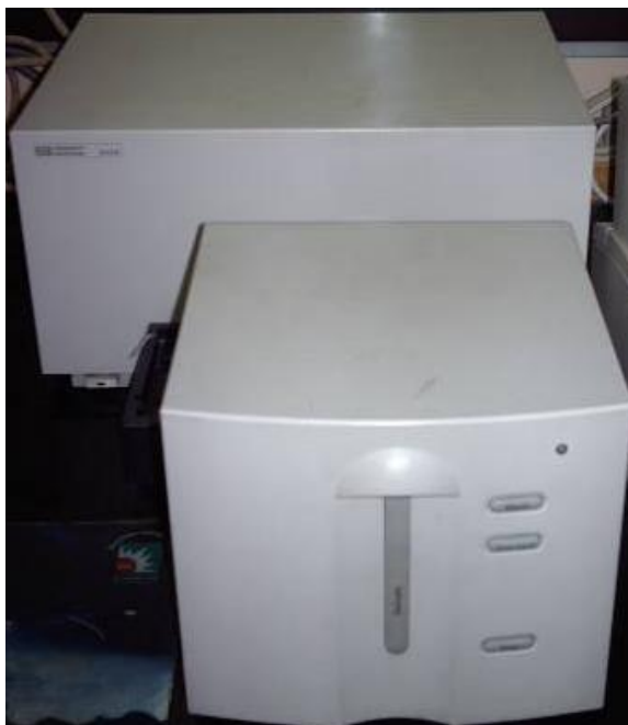
Figura 6. “Espectrofotómetro de UV-Visible marca HEWLETT PACKARD modelo 8453”. Fotografía tomada por Sequera Diana.
