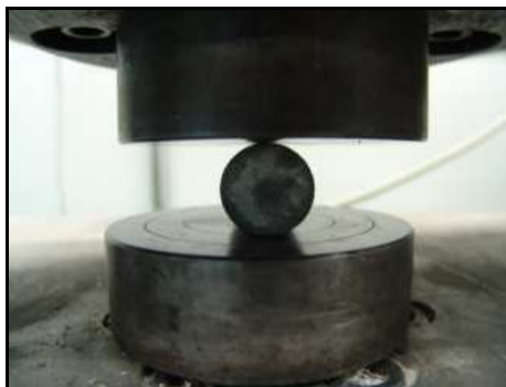
Figura 22. Ilustración del ensayo de tensión indirecta
