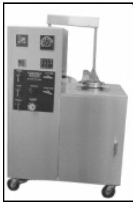
Figura 18. Cámara de curado presurizada
