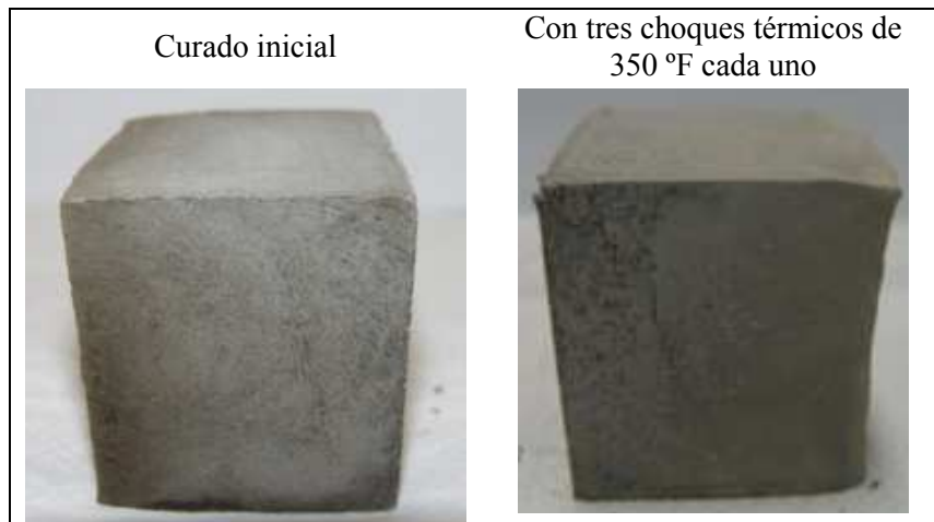
Figura 45. Fotografía de las muestras después del ensayo de resistencia a la compresión destructiva según la norma ISO 10426-2 [14] de la lechada de cemento formulada con microesferas de polímero (LMP 3) propuesta
