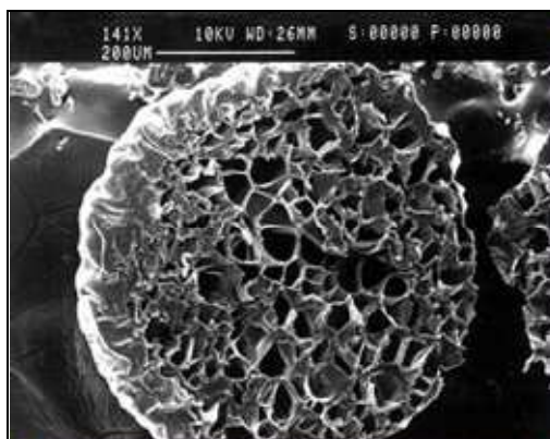
Figura 7. Fotografía tomada con microscopio electrónico de barrido de la estructura interna de las microesferas de polímero
