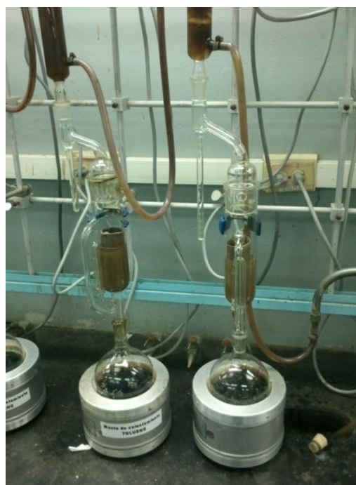
Figura A. 27 Lavado de arenas
