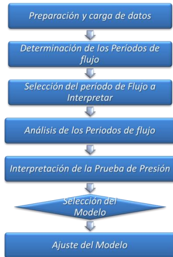
Fig. 4.2 Flujograma de Trabajo para la interpretación de las Pruebas de Presión
