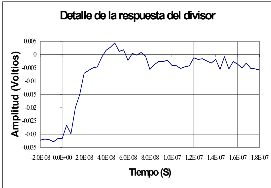
FIGURA 31: Detalle de la respuesta temporal del divisor ante escalón negativo
