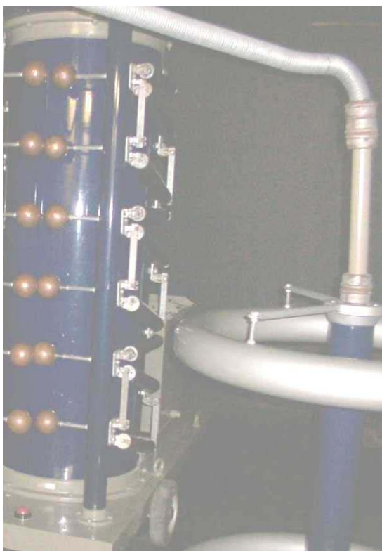
FIGURA 16: Parte superior del divisor de voltaje, con la resistencia amortiguadora
