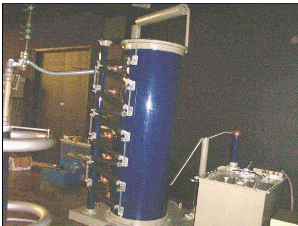
FIGURA 13: Foto del generador de impulso, de la fuente DC, y del divisor de voltaje
