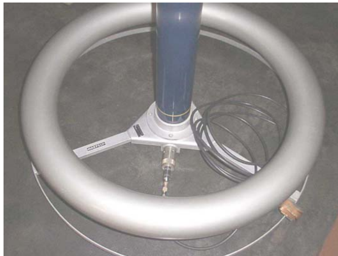
FIGURA 17: Parte inferior del divisor, con conector LEMO y cable coaxial
