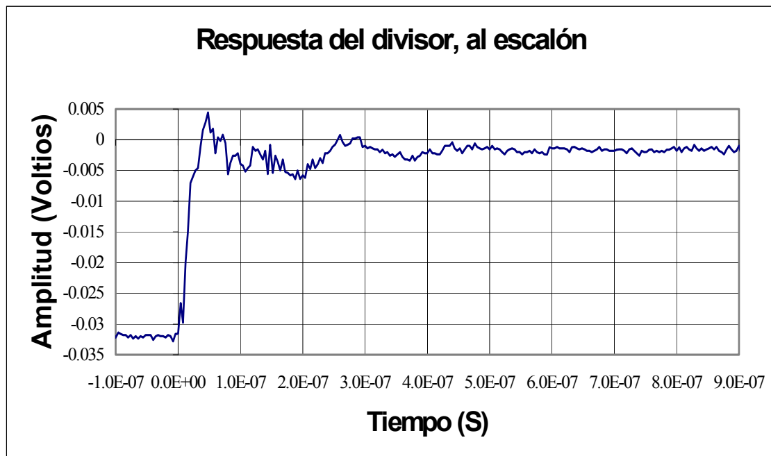
FIGURA 30: Respuesta temporal del divisor de voltaje ante un escalón negativo
