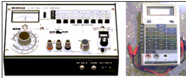
FIGURA 25: Puentes de impedancia analógico LCR-740 y digital ELC-120, con poco uso.
