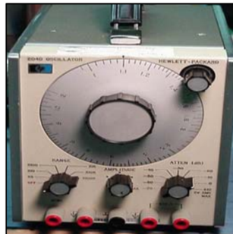
FIGURA 26: Oscilador sinusoidal Hewlett Packard HP204D, con poco uso.
