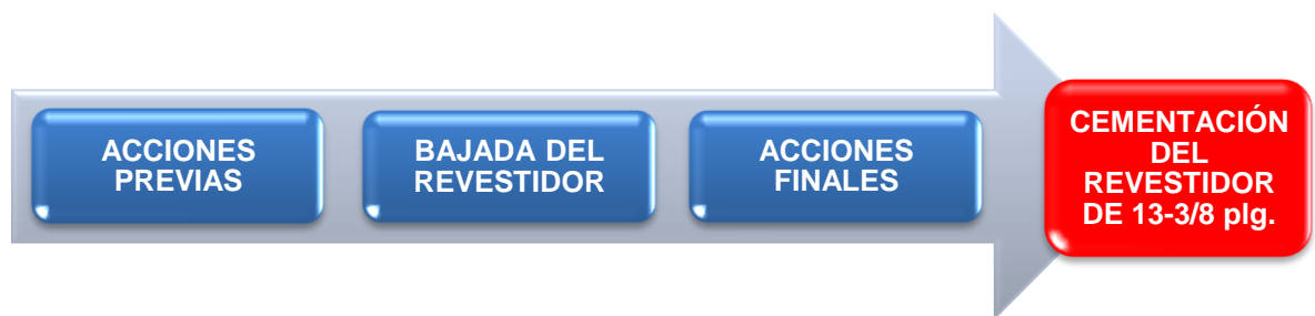
Figura 103 - Diagrama del proceso para la bajada del revestidor de 13-3/8 plg [Aristimuño y Briceño, 2012]
