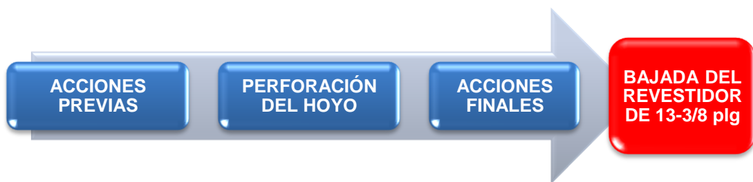
Figura 101 - Diagrama del proceso para la perforación del Hoyo Superficial 17-1/2 plg [Aristimuño y Briceño, 2012]
