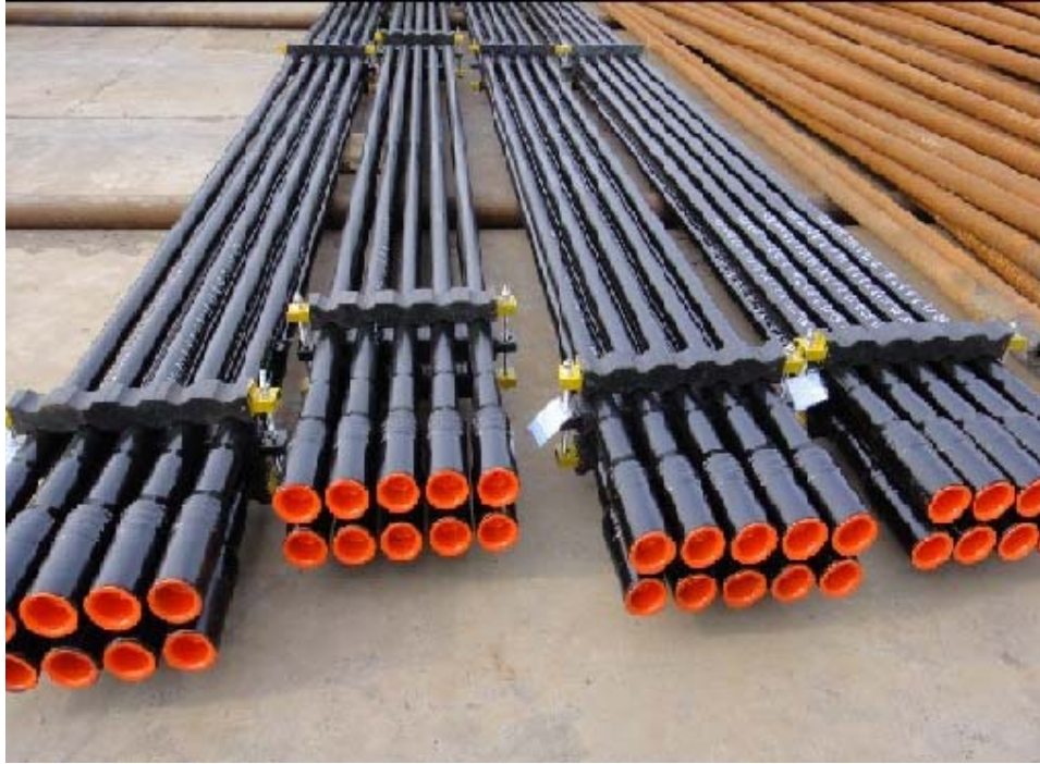
Figura II.22. Configuración estándar de una tubería de perforación. Fuente: www.aliimg.com
