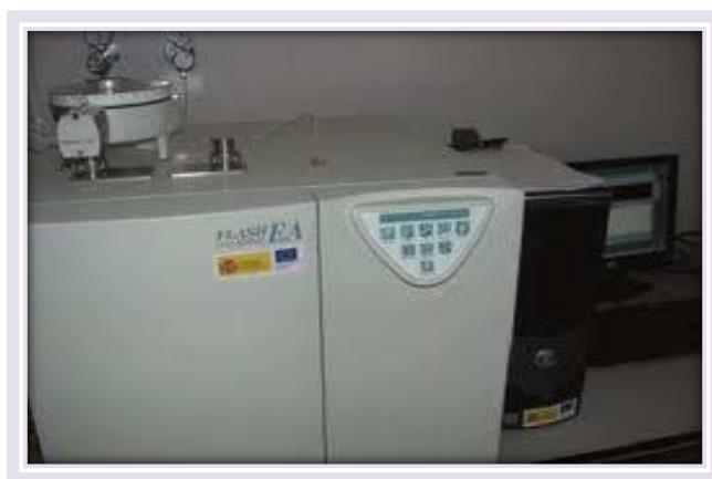
Figura N° 10: Equipo de análisis químico elemental.
