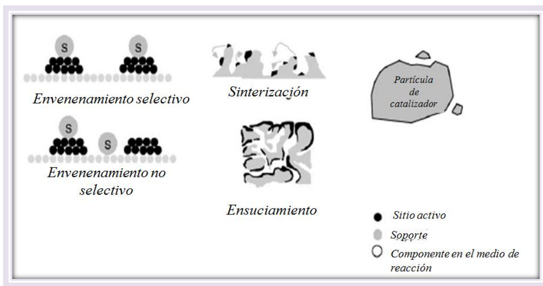
Figura N° 6: Tipos de desactivación en la catálisis heterogénea. Fuente: Moulijn J.A. y col. (2001)
