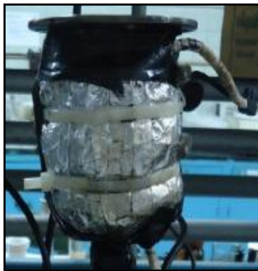
Figura N° 28. Tanque de alimentación recubierto con fibra de vidrio.
