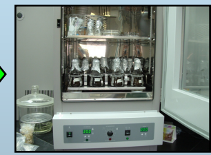
Condiciones de crecimiento (250 rpm a 30 °C)
