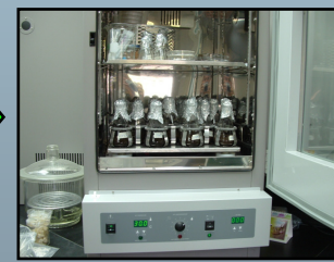
Condiciones del tratamiento (250 rpm, 30 °C)
