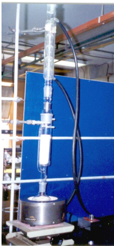
Figura N° 35: Equipo de extracción continua con etanol.
