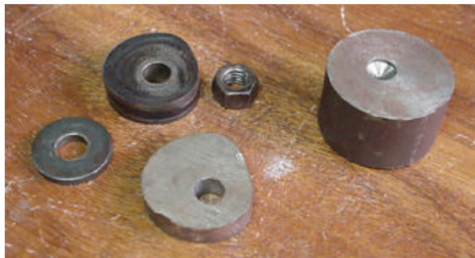
Figura 6.4. Dos levas mecanizadas a partir del tocho de la derecha, arandela y tuerca del montaje.
