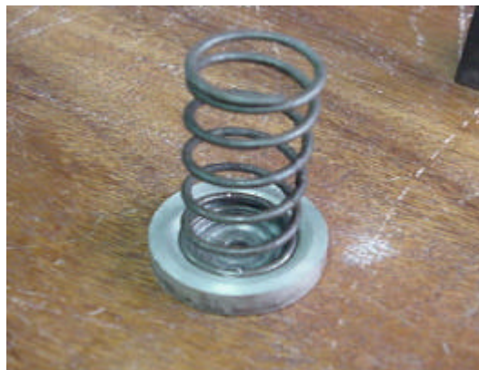
Figura 6.8 Resorte seleccionado y base del resorte mecanizada en un torno.
