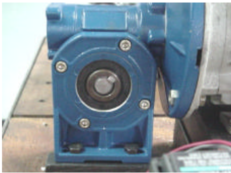
Figura 6.12. Árbol de la leva, reductor y detalle del acoplamiento del eje en el reductor
