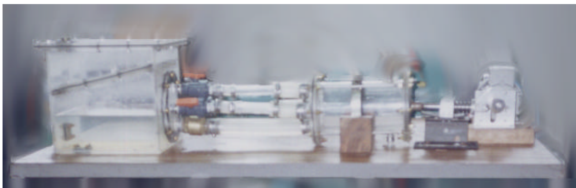
Figura 6.17. Banco de ensayos de dispositivos cardiovasculares.
