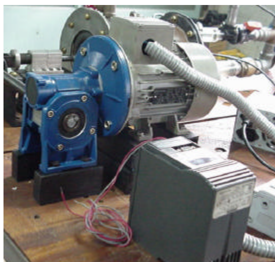
Figura 6.9 .Conjunto motor-reductor y regulador de frecuencia
