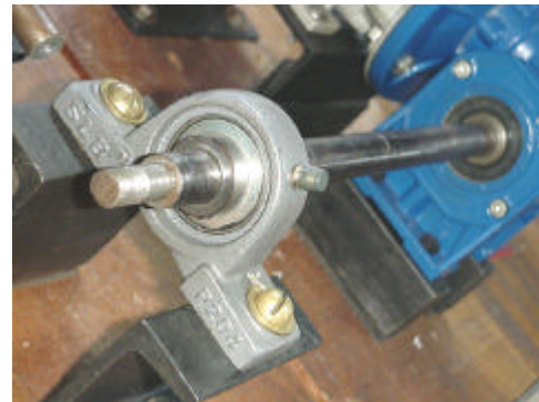
Figura 6.12. Árbol de la leva, reductor y detalle del acoplamiento del eje en el reductor
