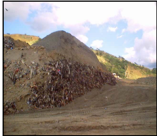
Fig. 76. Efecto Reforzador del Plástico en el Talud de Basura Ensayado a Escala Real
