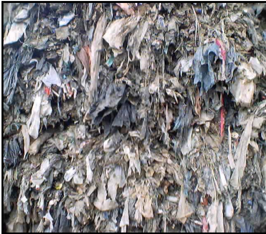
Fig. 75. Alto Contenido de Plástico en el Talud de Basura Ensayado a Escala Real
