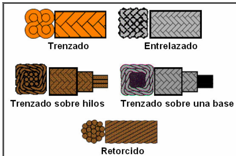
Figura 2.7 – Tipos de elaboración de Empaquetaduras
