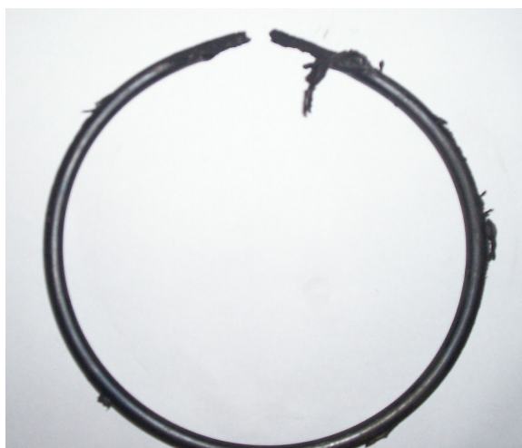
Fig. 5.12 - Falla Típica de los O-Rings.
