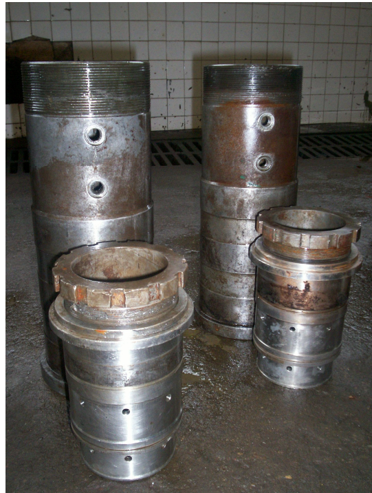
Arreglo de las empaquetaduras y anillos dentro de las camisas
