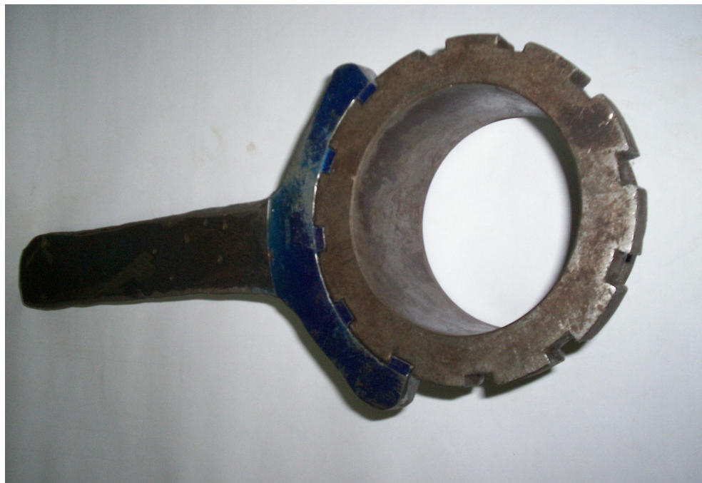
Llave terminada sobre la Tuerca Prensaempaques
