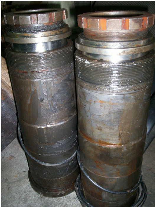
Arreglo de las empaquetaduras y anillos dentro de las camisas
